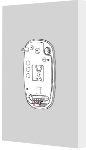
Şekil 7.2 ES Kablo Bağlantılarının Yapılması
